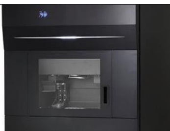
Дверца лотка выдачи с магнитным замком
