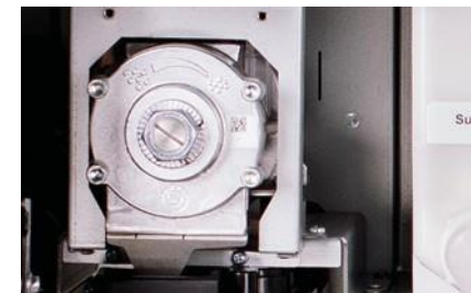
Кофемолка Ditting EMH64 с плоскими стальными 64-мм. жерновами
